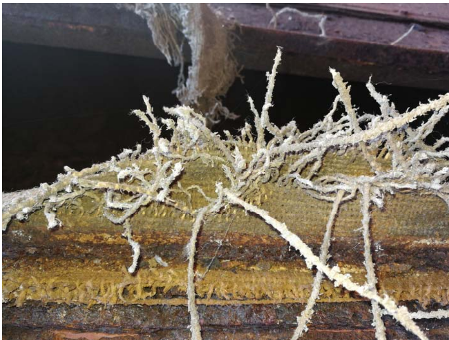
Foto n°6 – Guarnizione in tessuto di crisotilo (giunto condotta di ventilazione) (fonte: foto effettuata dal sottoscritto nel corso della direzione dei lavori di bonifica dell'ex fabbrica laterizi FIL di S. Caterina Albanese – Cs)
