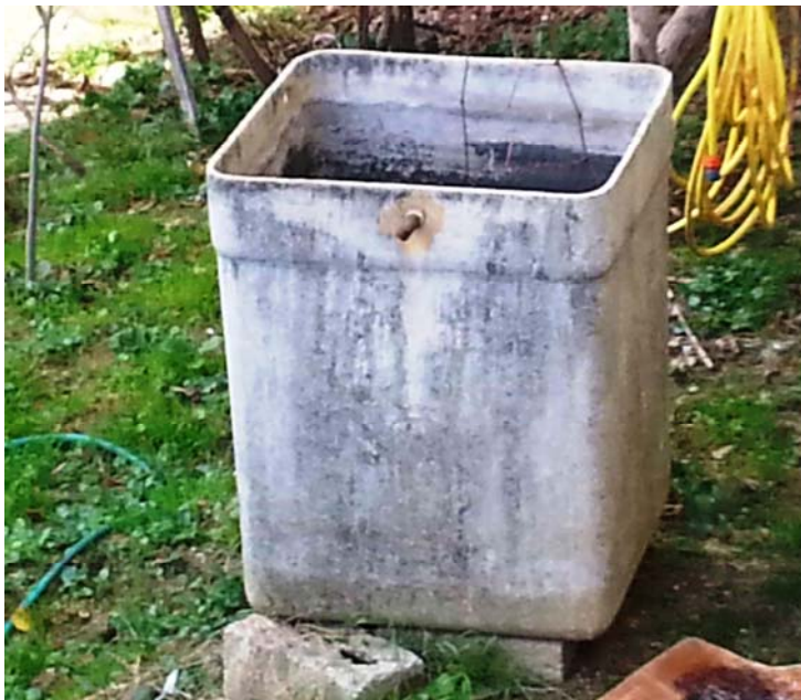
Foto n°2 – Serbatoio in eternit
